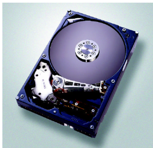
Figura 6.4 – L'interno di un hard disk (IBM Deskstar 180GXP): oltre alla superficie per la memorizzazione si nota il gruppo di testine il motore e l'elettronica di interfaccia.
